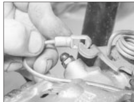
11.5a Unhook the handbrake cable . . .
